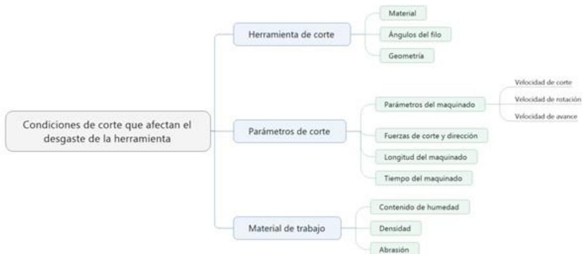
Figura 1. Factores comúnmente estudiados que afectan el desgaste de la herramienta en el fresado de la madera.
