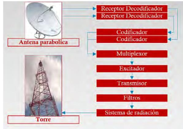
Figura 4 Arquitectura de una estación repetidora TDT
