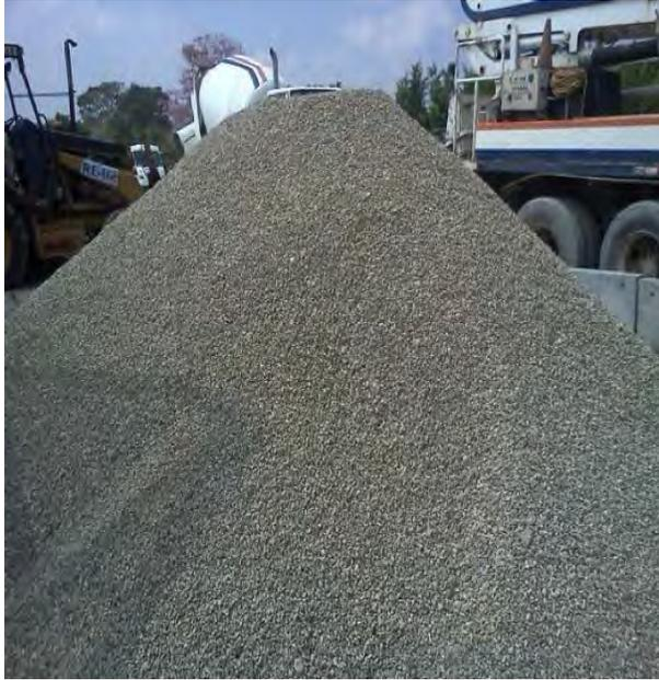
*Figura 3. Agregado grueso T.M.A. 10 mm.
