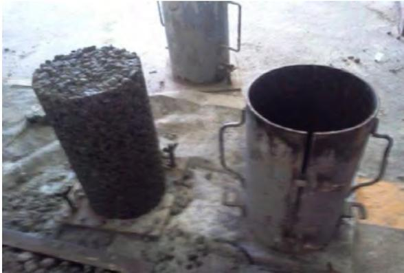
*Figura 5. Muestra cilíndrica para prueba a compresión.
