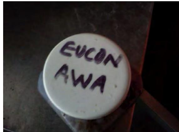
Figura 2. Aditivo EUCON AWA retarda el fraguado y da adherencia.
