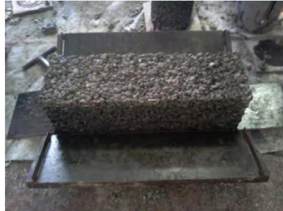
*Figura 6. Viga para prueba a flexión
