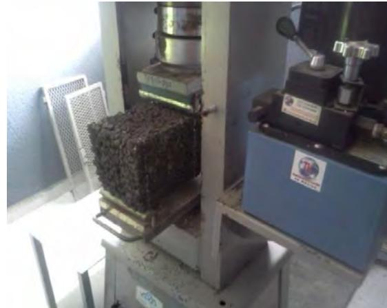
*Figura 8. Ensayo a flexión con carga en los tercios.
