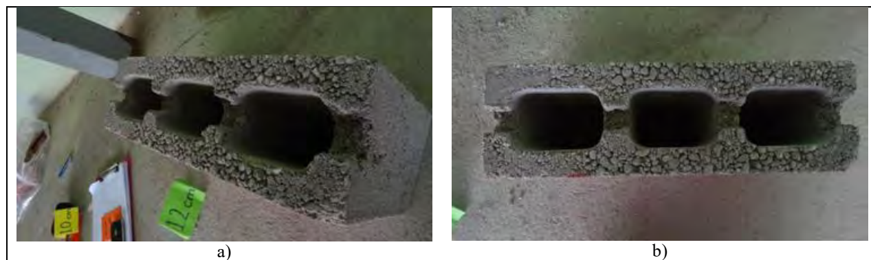
Figura 3.- Muestras en bloques huecos de concreto.
