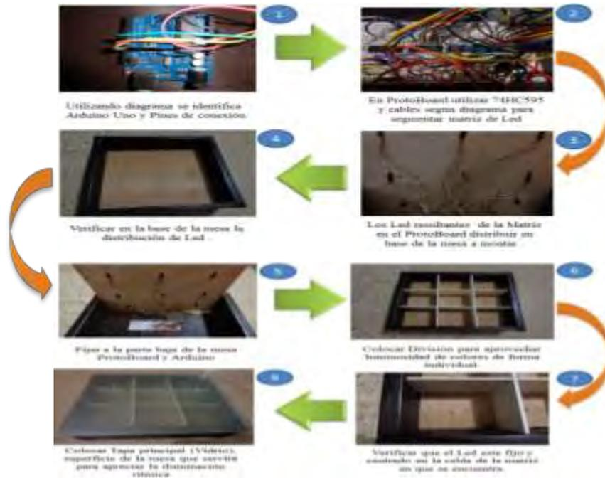
Figura 8. Proceso de manufactura (Fuente: propia de autores)
