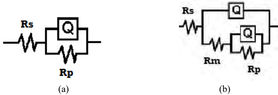
Fig. 3. Circuitos eléctricos equivalentes utilizado para el ajuste de datos de impedancia: R_s es resistencia a la solución, Q es un elemento de fase constante, R_{TC} es resistencia a la transferencia de carga y R_{mol} es resistencia de las moléculas.
