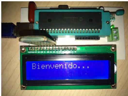
Figura 3. Sistema embebido conectado al botón del timbre
