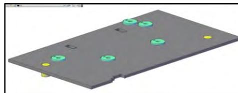
Dibujo No. 3 Ensamble de la guarda y bujes guía
