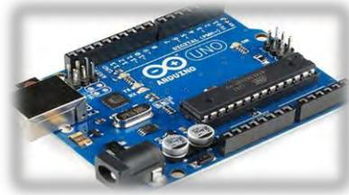
Imagen 1. Placa de Arduino Uno
