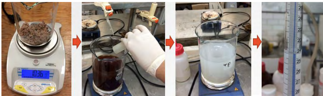
Figura 1. Ilustración de proceso para la determinación del número de Kappa.
