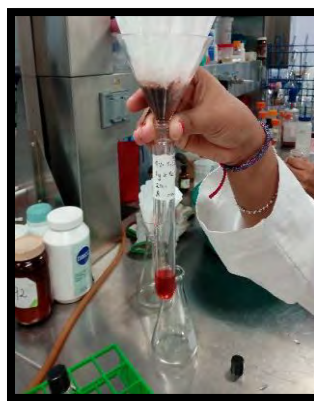
Figura 5. Filtración del hidrolizado
