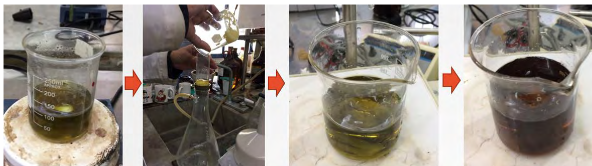
Figura 3. Ilustración de proceso para la determinación de alfa-celulosa.
