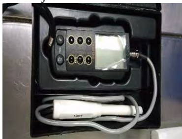
Figura 3. Potenciómetro utilizado para la medición de pH, temperatura y conductividad.
