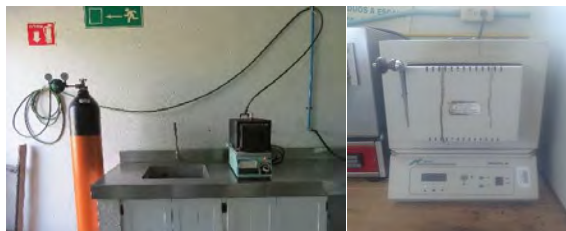
Figura 1. a) sistema acoplado para pirolisis con gas N 2 ; b) mufla de laboratorio convencional
