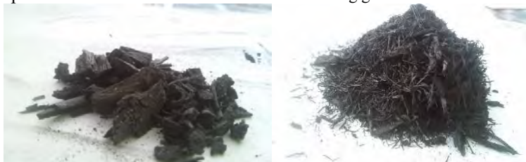
Figura 3. a) CA de pino mediante carbonización con N 2 ; b) CA de bagazo de caña carbonizado con O 2 .
