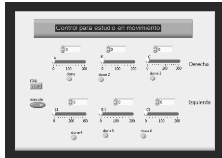
Figura 3 .Panel frontal 6 movimientos
