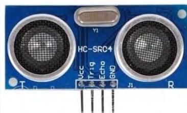
Figura 2. Sensor Ultrasónico hc-sr04.
