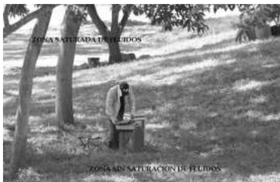
Figura 4.- En imagen se muestra la operación del equipo syscal swicht, con el cual se adquirieron datos de resistividad eléctrica. Se muestra con etiquetas las dos zonas consideradas a prospectar, una zona con continua invasión de agua fluvial por un lago artificial y la zona seca o libre de inundaciones recurrentes.
