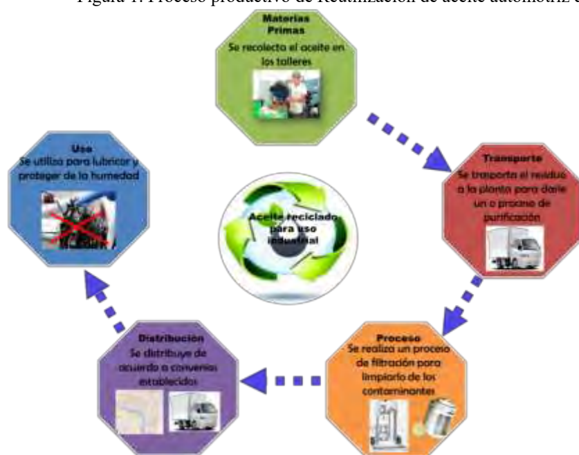
Figura 1. Proceso productivo de Reutilización de aceite automotriz quemado.
