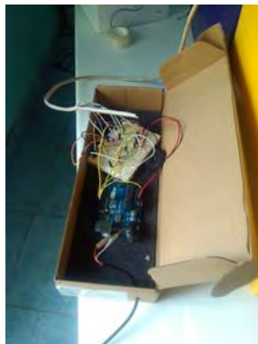
Figura 2. Conexiones con la placa de arduino uno
