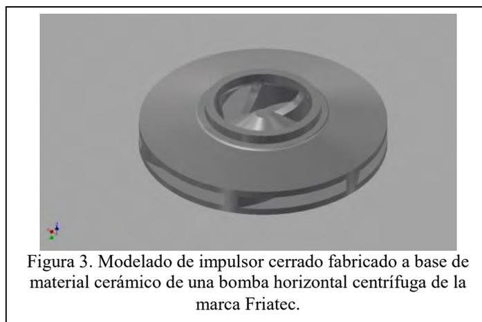
Posteriormente se buscó el diseño de un nuevo impulsor que simplificara su fabricación sin sacrificar su eficiencia, para ello se consideró que el material con mayor facilidad de conseguir y con un precio razonable, eran placas de Titanio. En adición, cabe mencionar que el proceso de soldadura de titanio, es un proceso con alto nivel técnico por parte del soldador, ya que una mala aplicación conlleva fisuras en el material que puedan generar una falla durante el equipo en operación.
