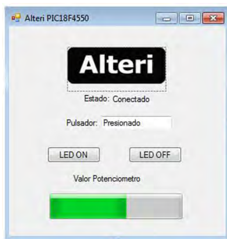
Figura 4. Interfaz Gráfica de Usuario con conectividad USB
