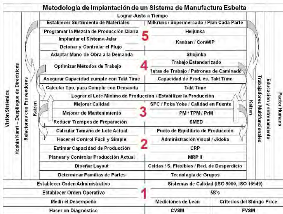
Figura 1. Metodología de Implantación de un Sistema de Manufactura Esbelta. Fuente: (Niño Luna & Bednarek, 2010)
