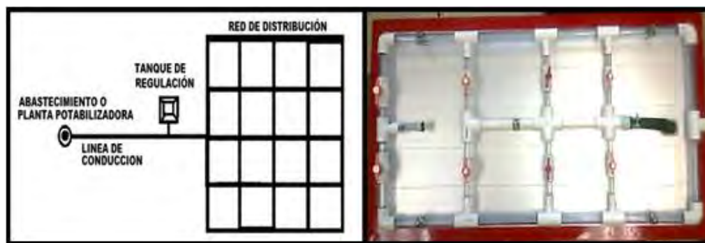
Figura 1. Esquema de una red de agua potable y red de distribución a escala.
