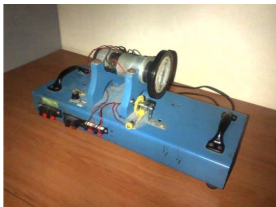
Figura 2: Planta instrumentada, motor de CD.
