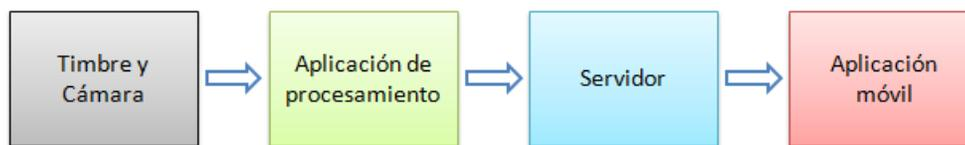
Figura 2. Diagrama a bloques de las partes que conforman el timbre inteligente
