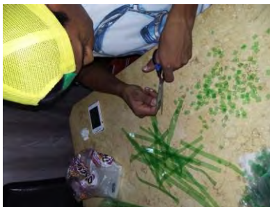
Figura 4. Corte de PET a la granulometría adecuada.
