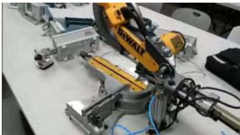
Figura 6 Máquina cortadora de madera con sistema de seguridad
