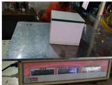
Figura 6. Cuantificación de la masa del recipiente lleno de la muestra granulométrica de PET.
