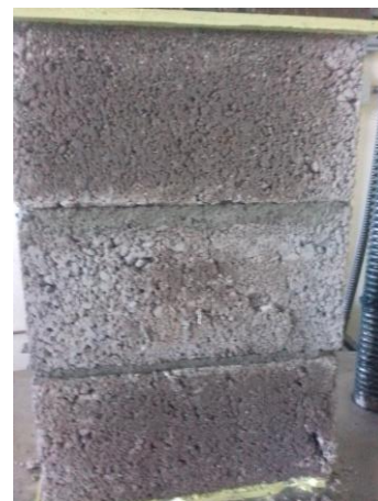
Figura 12. Falla de pila después de la carga
