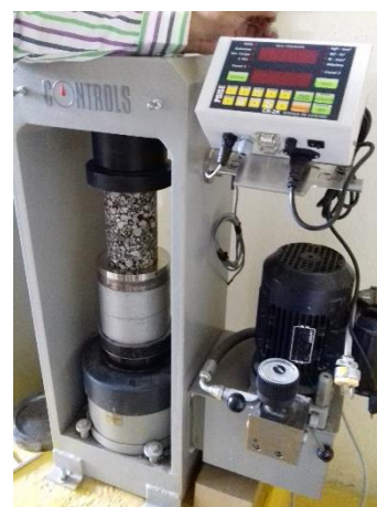
Figura 9. Ensaye a esfuerzo de compresión simple
