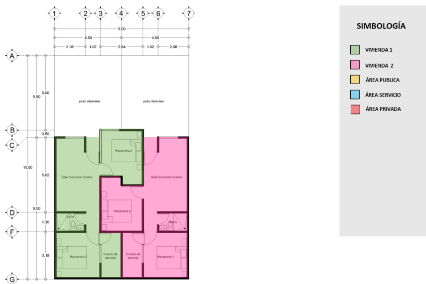
Figura 2. Planta Arquitectónica con división de predios
