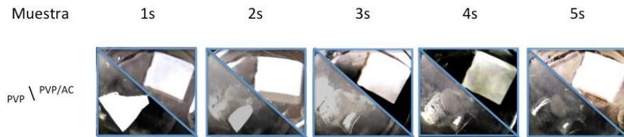
Figura 5. Prueba de humectación de membranas a base de PVP y PVP-AC.
