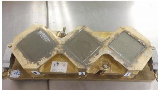
**Imagen 3. Muestreo de mezcla y colocado en molde**
