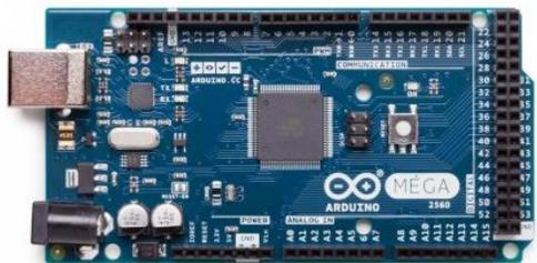
Figura No. 2. Placa de Arduino.
