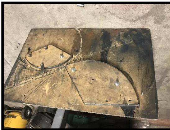
Figura 4. “Fixture” para doblar tubo.
