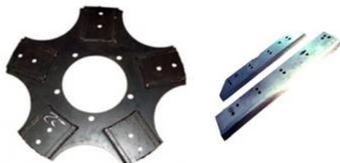
Ilustración 10.- Disco de cuchillas intercambiables
