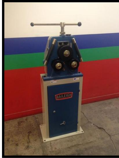
Figura 5. Máquina roladora de tubo.
