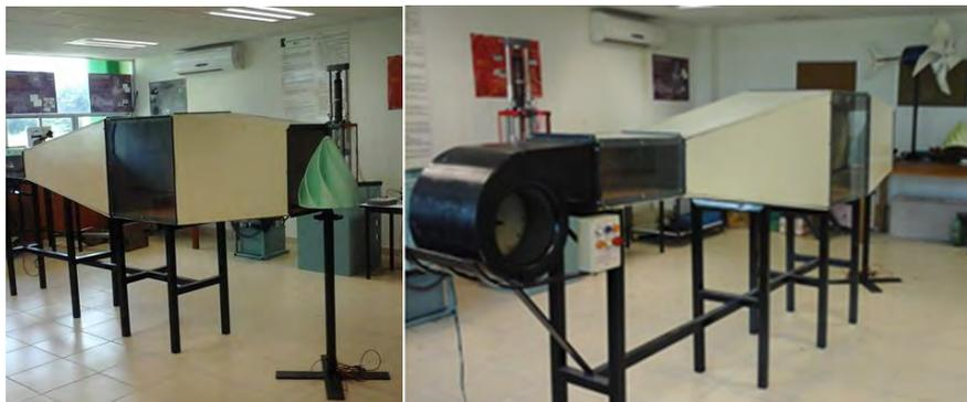
Fig.9- Túnel de viento TVE3-10 para ensayos de turbinas eólicas a nivel de laboratorio.
