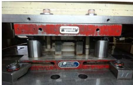
Figura 1- Troquel para fabricación de terminales
