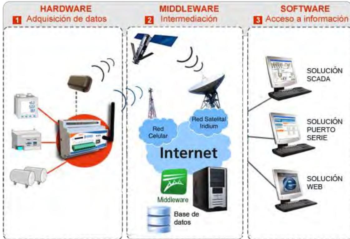
Figura 1 Diagrama de adquisición de datos
