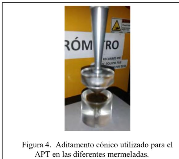
Figura 4. Aditamento cónico utilizado para el APT en las diferentes mermeladas.
