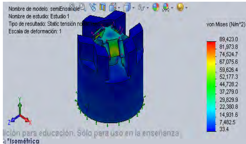
Figura 5 Análisis de tensión entre la base y el sujetador
