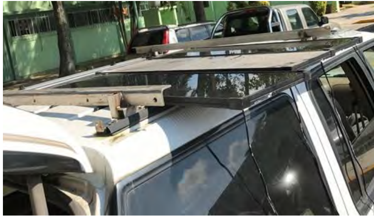
Figura 3. Instalación de paneles fotovoltaicos en parte superior del vehículo, sujetos con estructura metálica para evitar caídas. Puede observarse que en esta posición capta fácilmente la radiación solar. Fuente: elaborado por autores.
