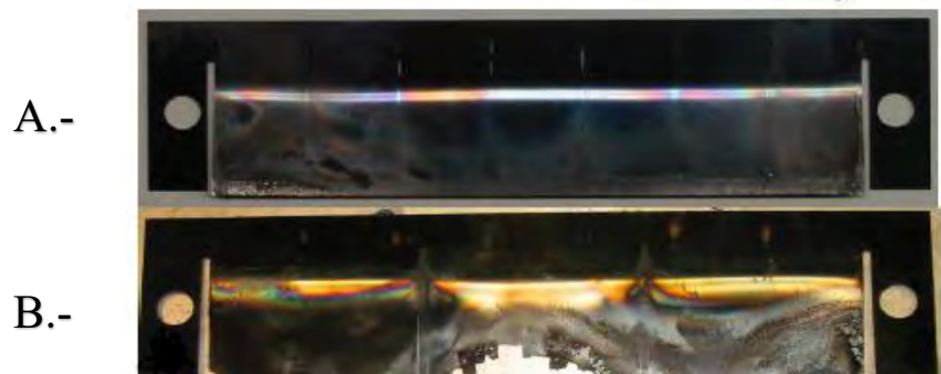
Figura 14. Válvula de Pulsorreactor Argus 1/5: A.- Antes de Operación y B.- Después de Operación. Imagen Tomada de (Litke et al., 2005).
