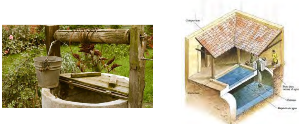
Figura 3. Derecha. Captación de agua de lluvia en aljibes. Izquierda. Pozo artesiano con brocal de concreto. Fuente: Ecured
