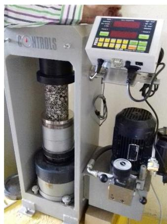
Figura 9. Ensaye a esfuerzo de compresión simple
