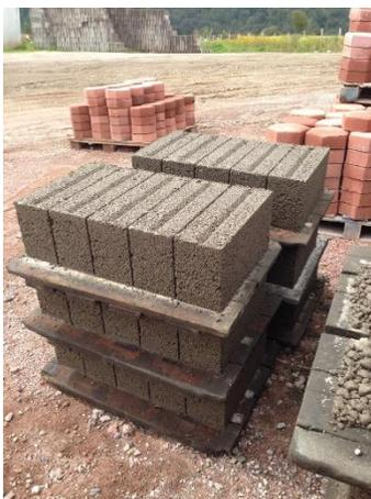
Figura 5. Blocks en proceso de secado
