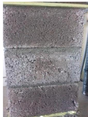
Figura 12. Falla de pila después de la carga
