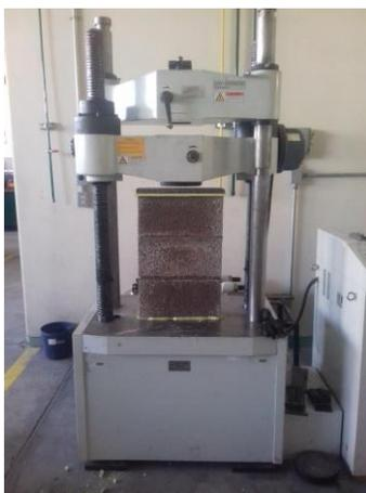
Figura 11. Carga axial sobre pilas
