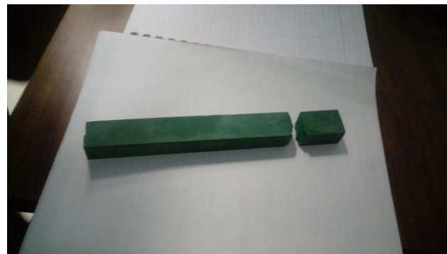
Figura 5 probeta después del ensaye de tensión
