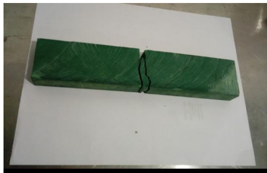
Figura 12 probeta después del ensaye de flexión
