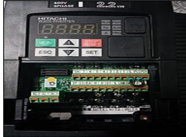
Figura 3. Fotografía del Variador de Frecuencias
