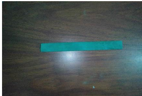
Figura 4 probeta antes del ensaye de tension
