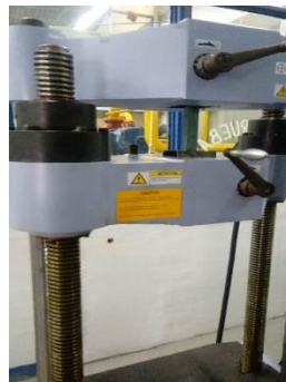
Figura1 probeta instalada en la Maquina universal de ensayes SHIMADZU
