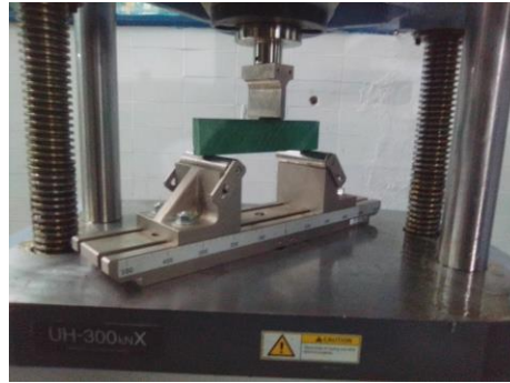
Figura 8 probeta instalada en la maquina Universal SHIMADZU
