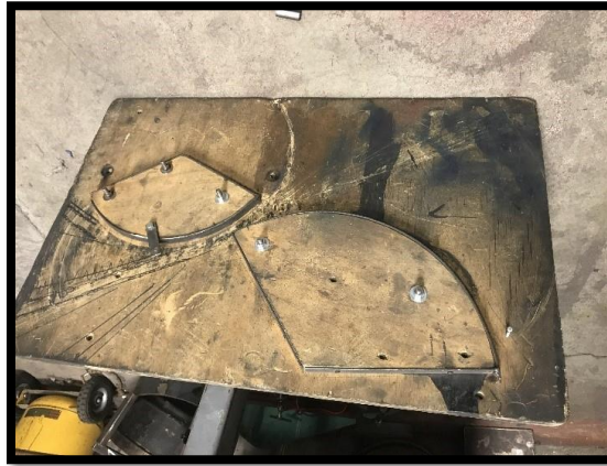
Figura 4. “Fixture” para doblar tubo.
