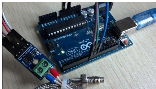
Fig. 7 sensor de temperatura MAX 6675 conectado a Arduino UNO
