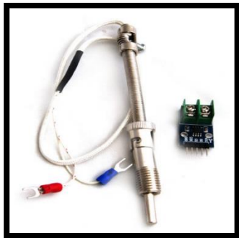
Fig 1.- Termopar y tarjeta de control
