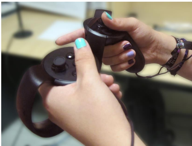
Figura 4. controles Oculus Rift con 6DOF e interfaces 2D.
