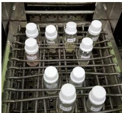
Figura 4. Equipo para las pruebas de hinchamiento.
