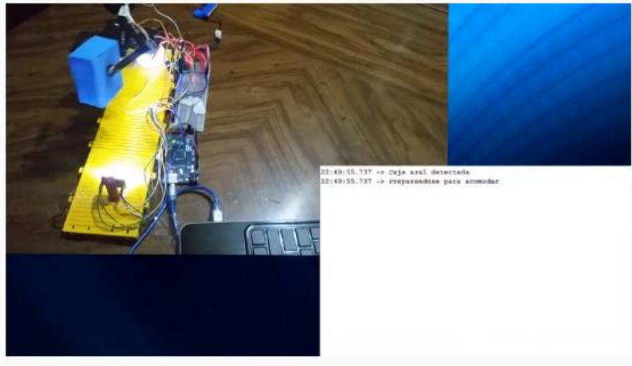
Ilustración 2.- el brazo robótico toma el objeto para moverlo a la siguiente posición
