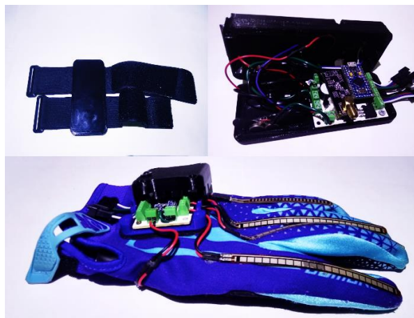
Figura 6 Guante de adquisición de datos totalmente armado.
