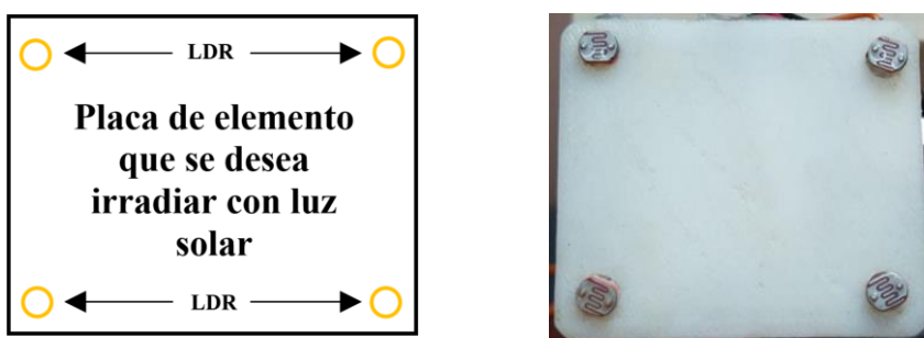
Figura 1. Placa de seguimiento de sol con sensores LDR en las esquinas, modelo real impreso en 3D.
