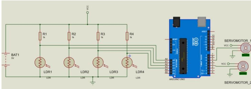
Figura 5. Circuito eléctrico de seguidor de sol.
