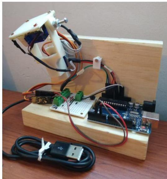
Figura 6. Prototipo de seguidor solar de dos ejes
