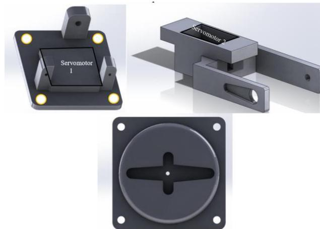
Figura 4. Piezas de ensamble mecánico, se observa en donde están ubicados los dos servomotores en el ensamble.
