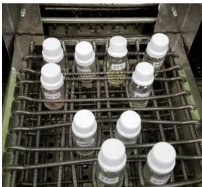
Figura 4. Equipo para las pruebas de hinchamiento.
