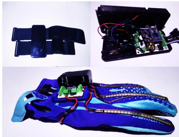
Figura 6 Guante de adquisición de datos totalmente armado.
