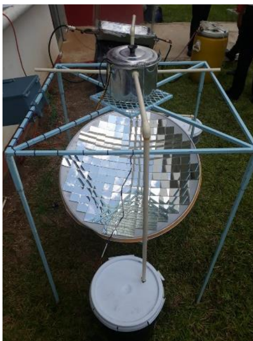
Figura 5 Prototipo de escaldador solar durante las pruebas de funcionamiento.
