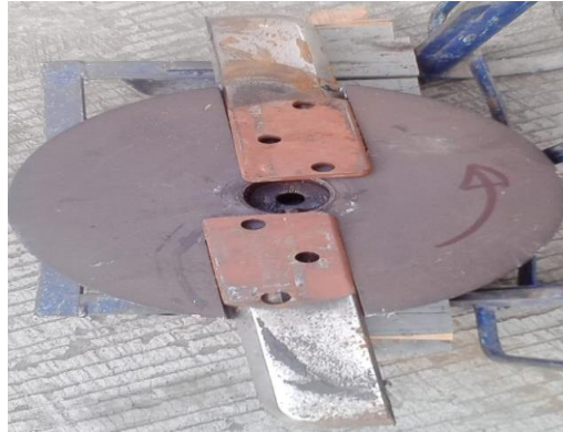
Fig. 2. Sistema de dos cuchillas rotatorias de la maquina compactadora.
