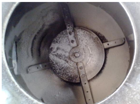
Fig. 5. Sistema de cuatro cuchillas rotatorias adicionadas a la maquina compactadora.
