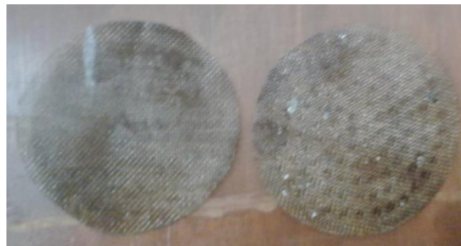
Fig. 4. Mallas dañadas con impurezas.
