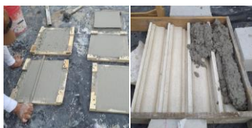
Figura 4.- Elaboración de losetas y molduras.
