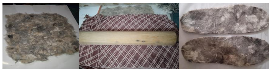
Figura 6. Obtención del no tejido punzonado
