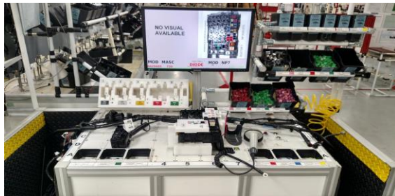
Figura 1. Tablero de inserción de fusibles
