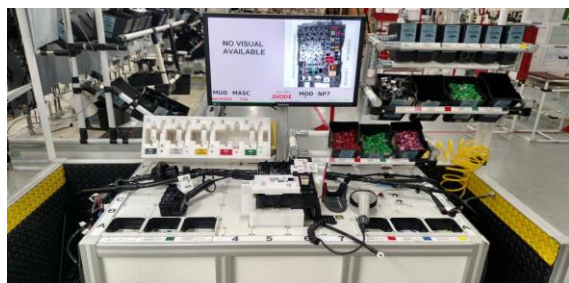
Figura 1. Tablero de inserción de fusibles
