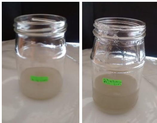
Figura 2. Mejores mezclas de unice (acetato de etilo y acetona): a) mezcla para barniz, y b) mezcla para adhesivo.
