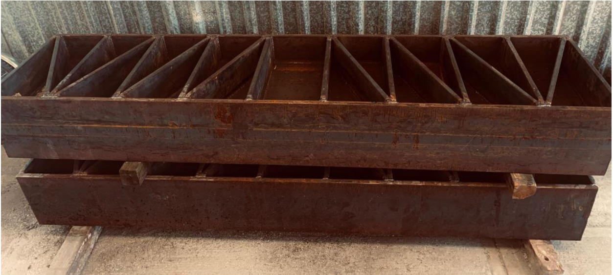
Figura 8 Travesaño seleccionado en primera etapa de manufactura
