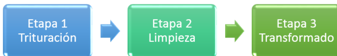
Figura 1. Etapas del proceso para reciclar y reutilizar el poliestireno expandido.
