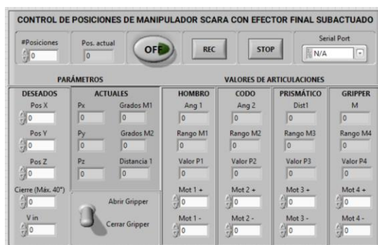
Figura 4. Panel frontal para controlar y visualizar los parámetros del manipulador SCARA.
