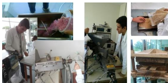
Figura 3. Preparación de la mezcla HDPE/AMP, su procesamiento térmico y moldeo por compresión para obtener placas de WPC.
