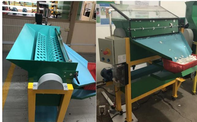
Figura 7. Máquina lavadora de unicel triturado.
