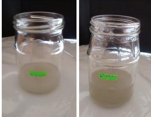
Figura 2. Mejores mezclas de unigel (acetato de etilo y acetona): a) mezcla para barniz, y b) mezcla para adhesivo.
