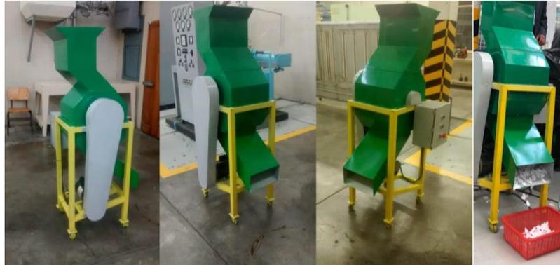
Figura 6. Máquina trituradora de unicel.
