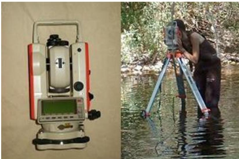
Figura 2. Levantamiento topográfico con estación total.
