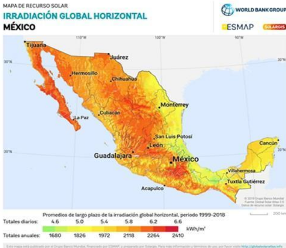
Figura 1. Recurso solar. Irradiación global horizontal de México promedio de 1999-2018 Fuente: Imagen capturada de Solargis 2017 y World Bank Group.
