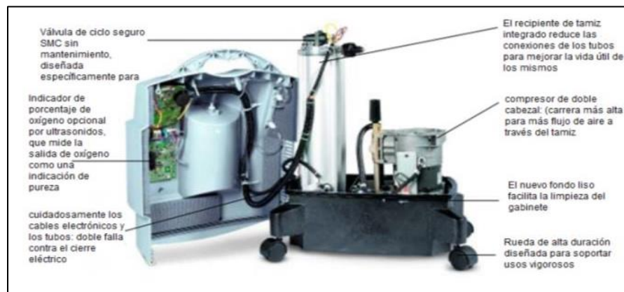
Figura 1: Partes Internas del Respirador M10
