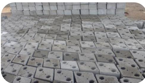
Figura 8.- Bloques romboidales
