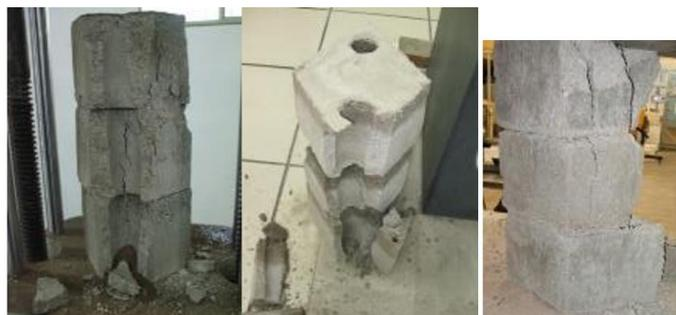
Figura 10. Patrón de colapso en pilas
