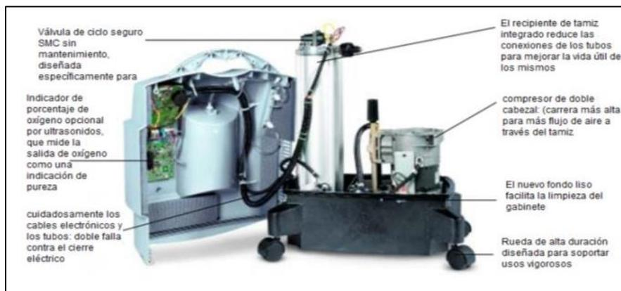
**Figura 1: Partes Internas del Respirador M10**
