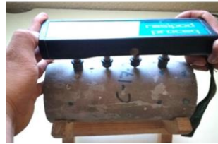
Figura 3. Prueba de resistividad eléctrica
