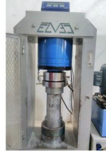
Figura 2. Prueba de resistencia a compresión
