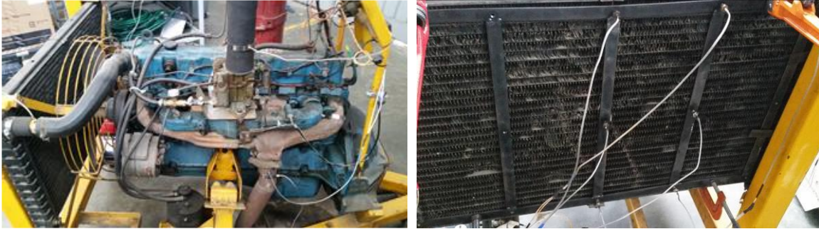
Figura 1. Motor de combustión interna (izquierda); radiador en banco de pruebas (derecha).
