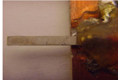
Figura 3: Trampolín PZT (1), longitud 6.53m m, con una de película de etil celulosa
