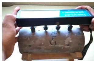
Figura 3. Prueba de resistividad eléctrica
