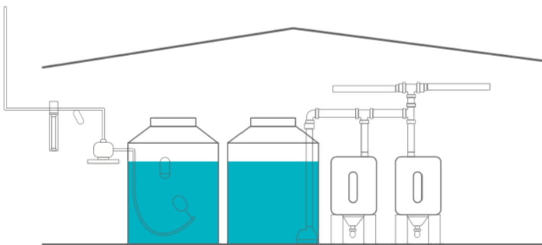
Figura 2. Sistema de recolección de agua pluvial (Ayuntamiento de Xalapa, 2021)
