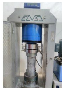
Figura 2. Prueba de resistencia a compresión
