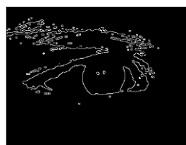
Figura 5. Resultado de la identificación de bordes por el método de Canny.
