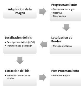
Figura 1. Fases para la segmentación del iris, utilizando la transformada de Hough
