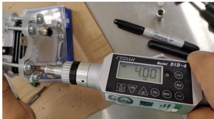
Figura 4. Ajuste de los tornillos del stack a 4 lb-in.
