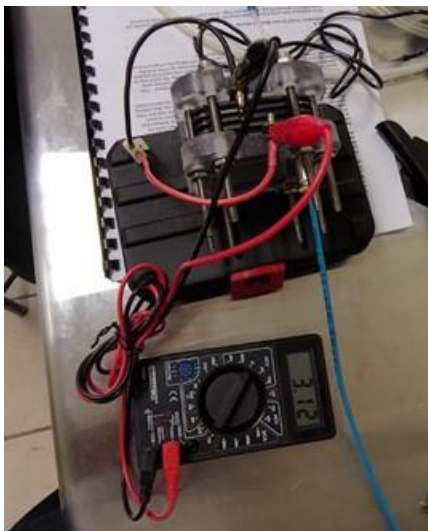
Figura 6. Medición del potencial a circuito abierto en la celda de combustible.
