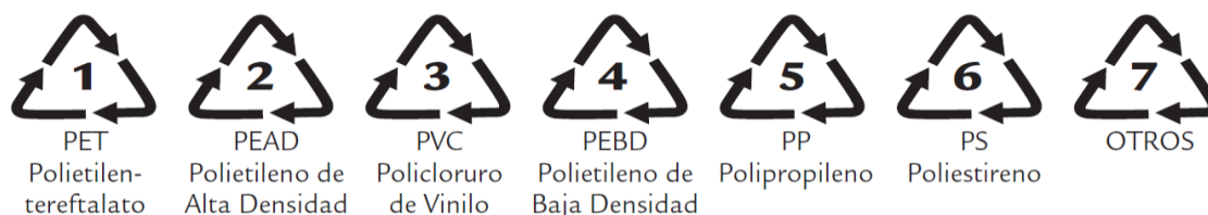
Figura 3: Identificación de residuos plasticos de botellas y contenedores Fuente: Codigo internacional SPI (Sociedad de Industrias de Plastico), 1988.
