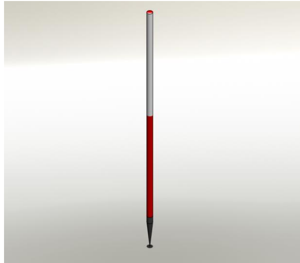
Imagen 1: Baliza de un metro de madera con punta Fuente: Elaboración propia con el software SolidWorks versión 2018, 2019.
