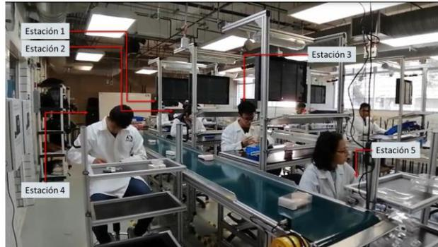
Figura 2. Distribución de la línea de ensamble- método estadístico
